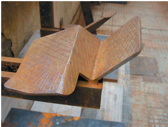
Fig. 4 - Le métal est incisé, puis nettoyé, avant de recevoir le tampon d'époxy. Cliché Violaine Pillard
